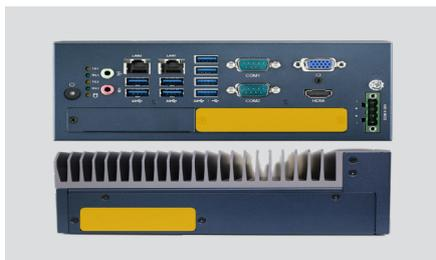
Les modules Flex I/O et iDoor permettent de facilement étendre le nombre et le type d'entrées/sorties (communication filaire, sans fils, vidéo, déport alimentation, etc.).
